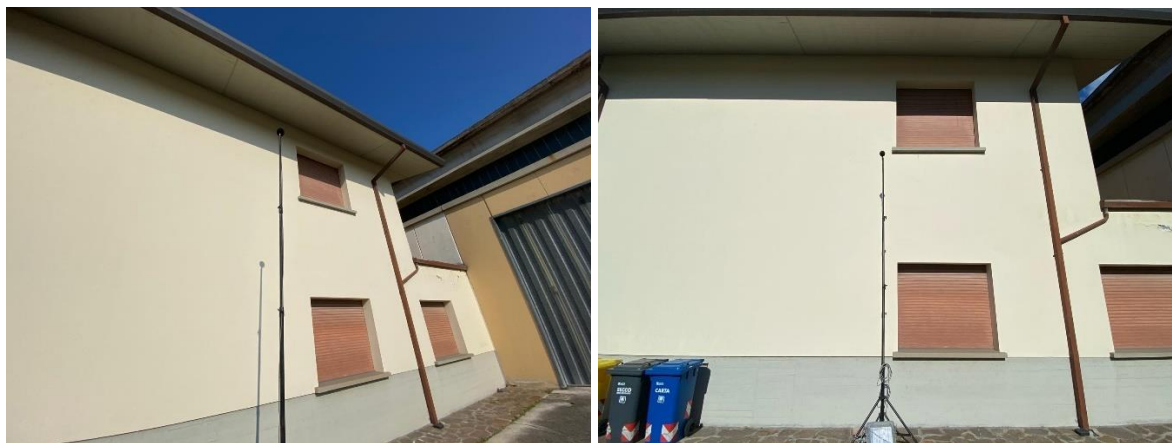
Figura E:5 Posizionamento fonometro presso il ricevitore R5 a impianto fermo (sx) e a impianto acceso (dx)
